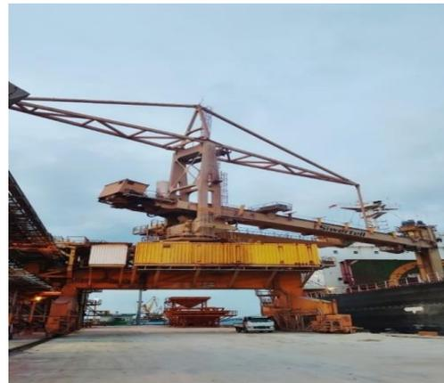
**Gambar 13. Continuous Ship Unloader CSU** merupakan peralatan unloading yang digunakan untuk mengangkat bahan baku produk (pupuk) dari kapal kemudian ditujukan ke gudang penyimpanan melalui belt conveyor yang terhubung dengan outlet CSU.
