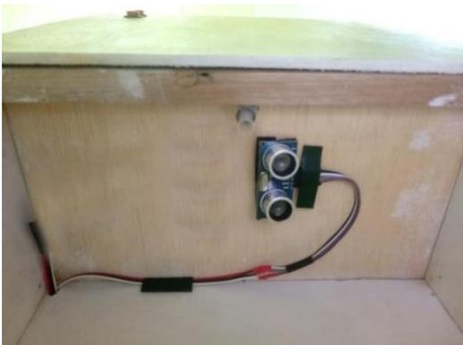
**Gambar 11. Sensor Pendeteksi Ketinggian Air**
