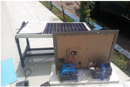
Gambar 8. Pengambilan Data Pembacaan Tegangan Panel Surya
