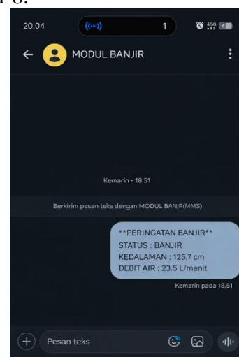
Gambar 8. Notifikasi SMS dari Modul SIM800L
