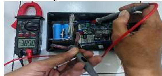
Gambar 3. Pengujian Sensor Tegangan
