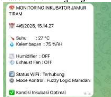
Gambar 9. Tampilan Monitoring Telegram Bot pada Sistem Inkubator Jamur Tiram
