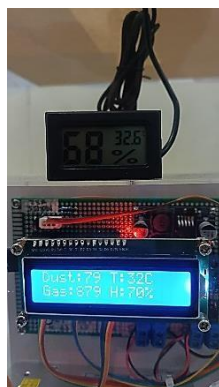
Gambar 8. Pengujian Suhu & Kelembaban
