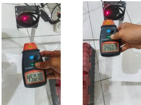
Gambar 11. Kecepatan PWM Kipas Intake & Outake
