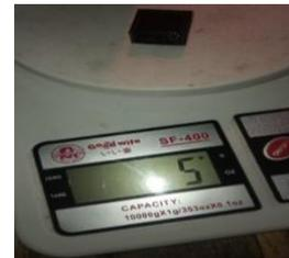
Gambar 13. Pengukuran mssa benda uji
