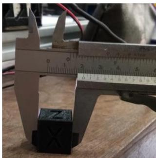
Gambar 11. Pengukuran Pruduk 20 mm
