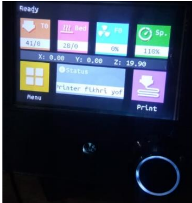
Gambar 9. Tampilan Home LCD Kalibrasi alas cetak dengan menggunakan system auto leveling
