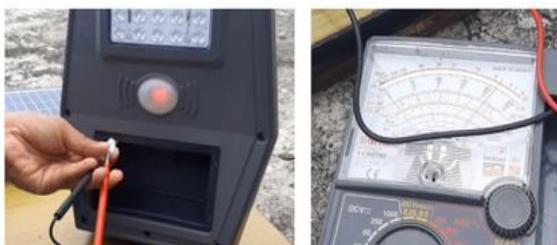
**Gambar 4. Pengukuran tegangan keluaran dari Solar Cell**
