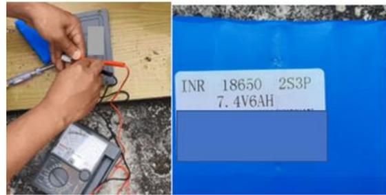
**Gambar 5. Pengukuran tegangan keluaran dari baterai**
