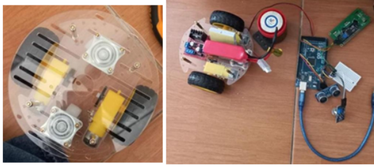
Gambar 5. Proses perakitan komponen pada acrylic plate
