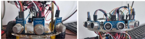
Gambar 6. Perakitan Sensor MQ-6 dan Sensor Ultrasonik pada Acrylic Plate
