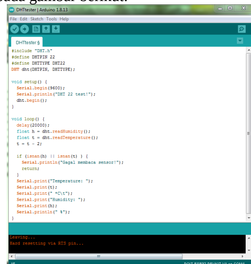
Gambar 5. Program Pengujian Sensor Kelembaban Udara
