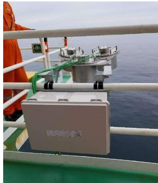
Gambar 3. Wave Recorder yang terpasang di platform minyak dan gas lepas pantai di FPU Jangkrik, Enimura Bakau B.V
