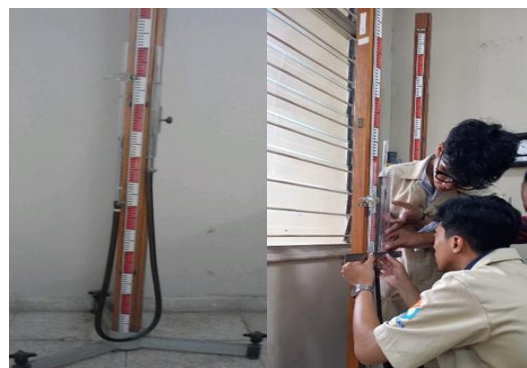
Gambar 1. Alat percobaan hukum Boyle di laboratorium fisika terapan
